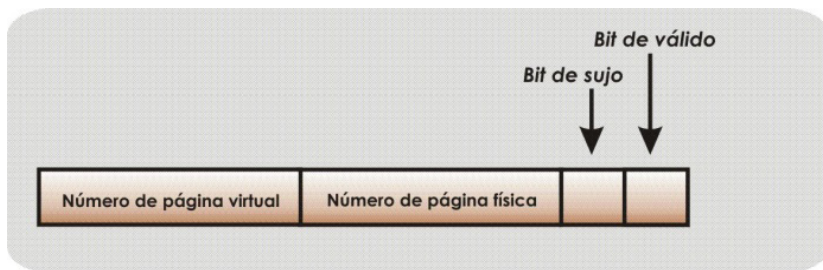
Figura 8.10: Entrada TLB. Figura adaptada de [Carter, N.]
