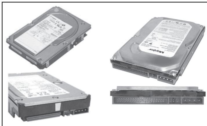
Figura 24: Exemplo de um disco com interface IDE e SCSI, respectivamente
