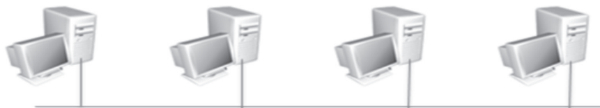
Figura 56: Ilustração da interconexão interna de um hub.
