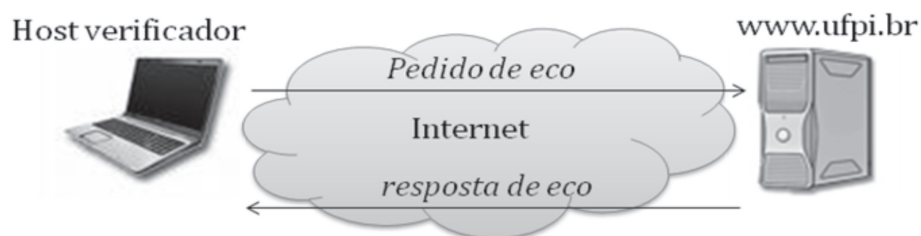
Figura 37: Ilustração do processo de verificação de operabilidade da interface de rede do host www.ufpi.br através do programa ping.
