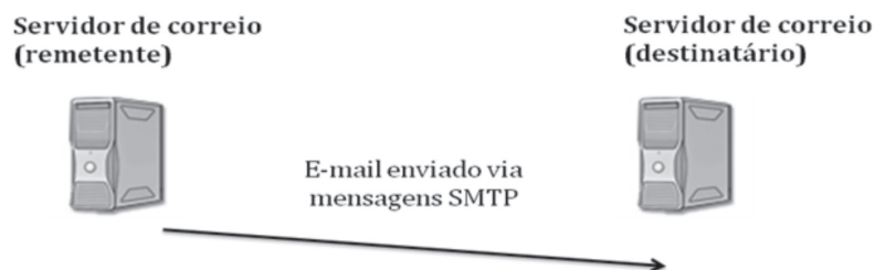
Figura 20: Envio do e-mail do servidor de correio do remetente para o servidor de correio do destinatário através de mensagens SMTP.
