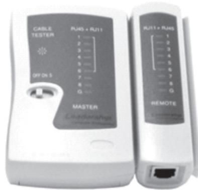
Figura 10– Exemplo de equipamento para teste de cabo de rede
