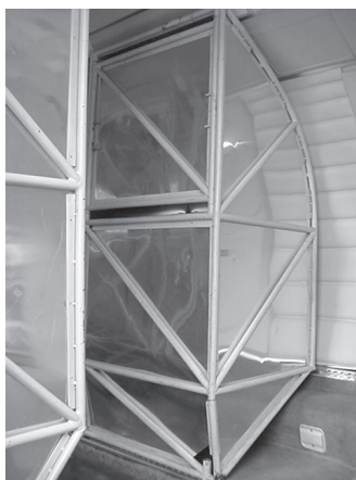
Figura 11: Container montado na aeronave Fonte: N. Borges (2005)
