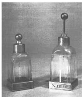
Eletroscópios de folhas de ouro de Bennet.
