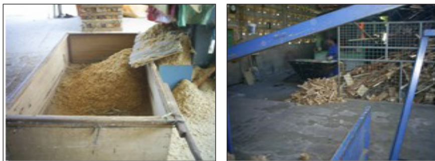
Figura 30 – Resíduo (pó e retalhos de madeira) oriundo da atividade de móveis reaproveitados como lenha
