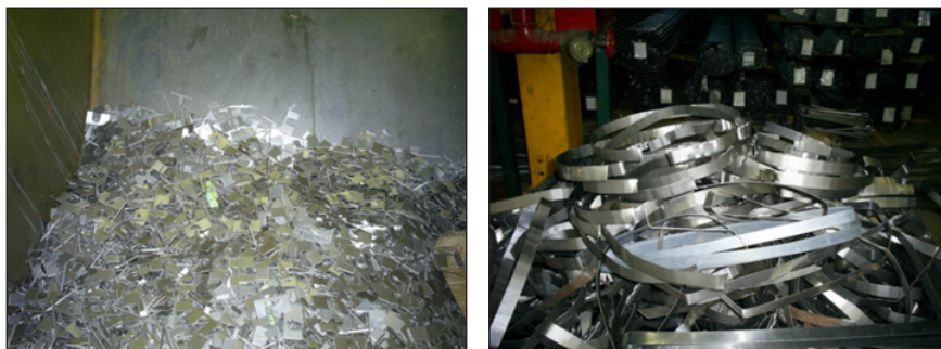
Figura 29 – Resíduo de alumínio e aço gerado da atividade de fabricação de bicicletas
