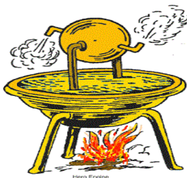
Figura 17 - Máquina de Heron ( eolípila )
