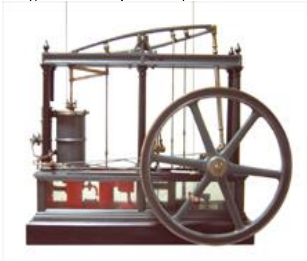
Figura 21 - Máquina a vapor de James Watt
