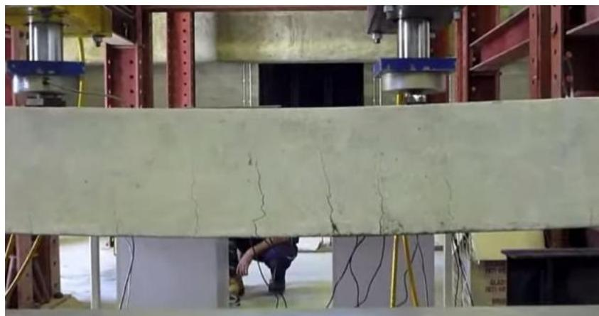
**Figura 1.** Demonstração de fissuras no centro da viga indicando tração na face inferior da peça por imposição de flexão simples [1].
