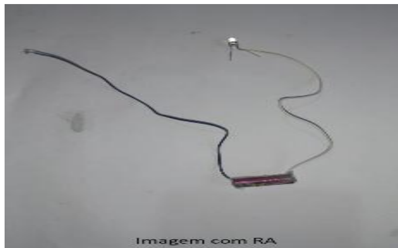
Figura 5 – Exemplos de circuito elétrico com chave aberta.
