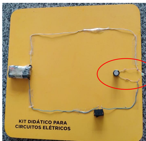
Figura 11 - Circuito simples constituído de um capacitor eletrolítico e um LED.
