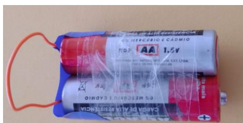
Figura 5 – Ligação em série das duas pilhas.
