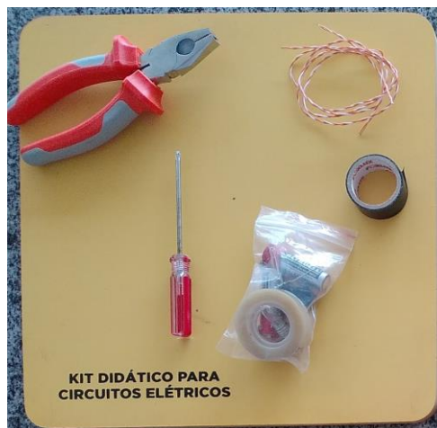
Figura 22 - Kit didático para circuitos elétricos com pilhas, resistores, capacitores, fios, fitas isolante e durex, interruptor, chave de fenda, alicate de corte e LEDs.
