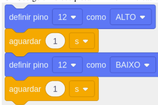
Figura 18 – Código em bloco pisca LED no Tinkercad circuitos.
