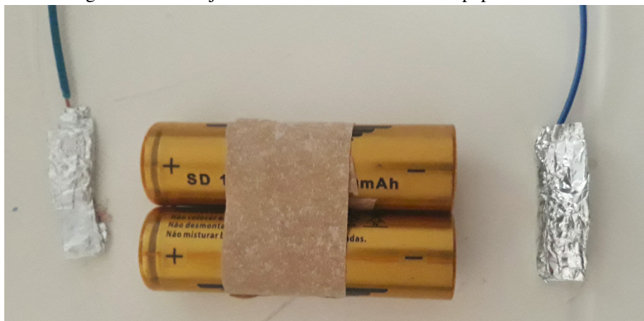
Figura 79 – Arranjo das baterias com contatos de papel alumínio.
