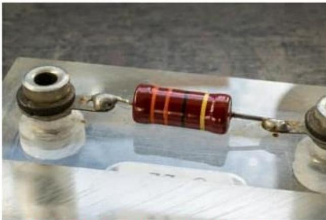
Na figura, temos um resistor cerâmico, presente em grande parte dos circuitos elétricos.
