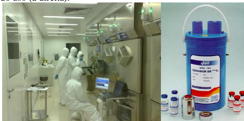
Figura 4: Laboratório de produção de radiofármacos (à esquerda) e radiofármaco pronto para transporte e preparação no momento do uso (à direita).
