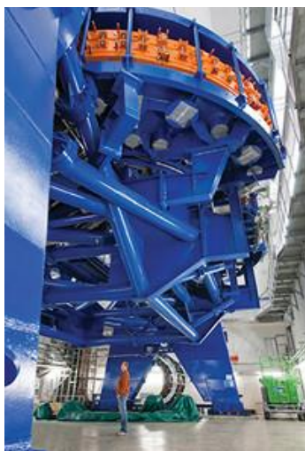
Figura 19: Acelerador Cíclotron- Estrutura de 670 toneladas que direciona os feixes de partículas: precisão milimétrica contra tumores.
