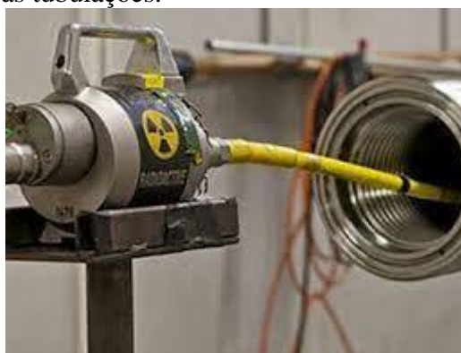
Figura 12: Aparelho de radiografia aplicado às tubulações.
