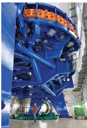
Figura 48 – Acelerador Cíclotron- Estrutura de 670 toneladas que direciona os feixes de partículas: precisão milimétrica contra tumores.
