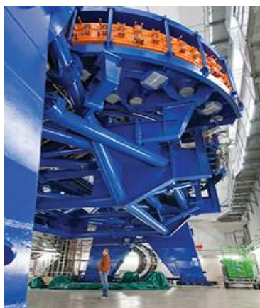
Figura 69: Acelerador Cíclotron-Estrutura de 670 toneladas que direciona os feixes de partículas: precisão milimétrica contra tumores.
