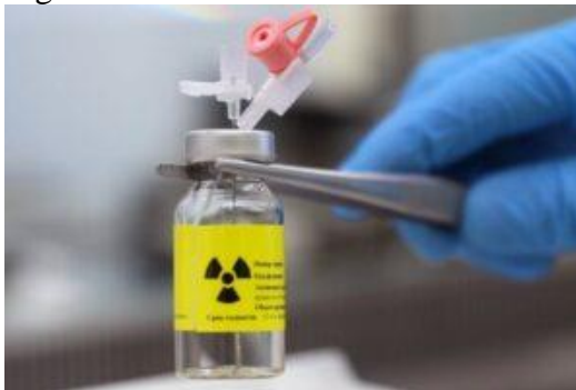
Figura 47 – Fonte não selada de radiofármaco.
