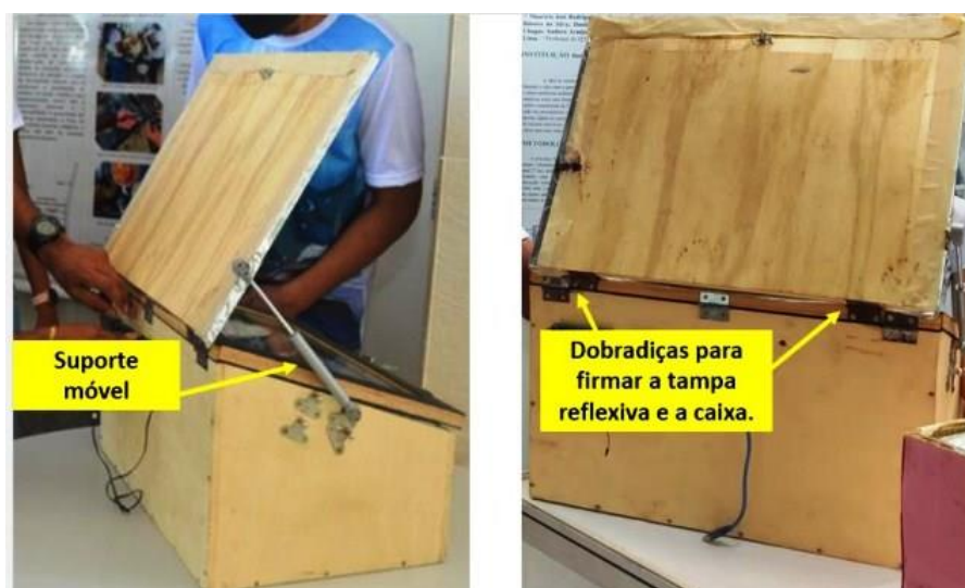
Figura 12. Ajustando a tampa refletora do forno.
