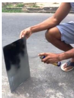
Figura 04. Pintura da chapa de aço
