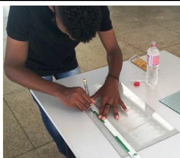
Figura 06. Corte do vidro transparente
