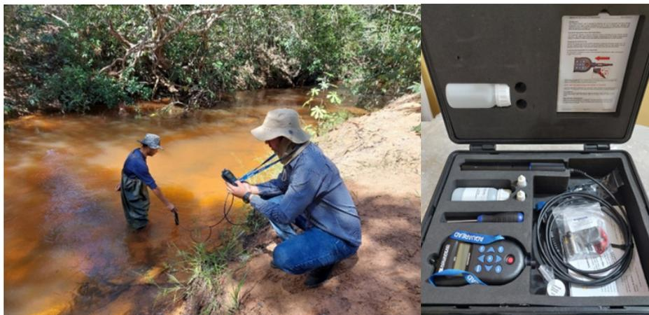
Figura 6 - Medição *in situ* dos parâmetros de qualidade da água (esq.) e sonda utilizada (dir.). Foto: equipe de campo.
