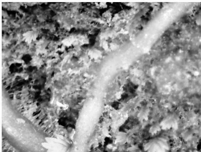
Figura 3: Acentuada proliferação de líquens e raiz rupestre. Pontos negros indicam que parte do suporte rochoso já se encontra alterado irreversivelmente.
