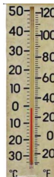
**Figura 1.5** Termômetro graduado nas escalas Celsius, à esquerda, e Fahrenheit, à direita.
