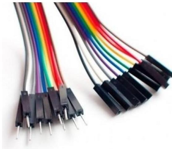
Extremidade dos jumpers tipo macho (esquerda) e tipo fêmea (direita)
