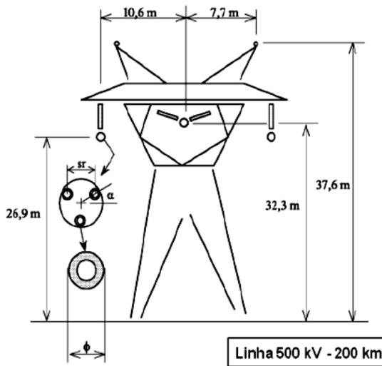
Figura 3 - Modelo da Torre de Transmissão de 500kV
