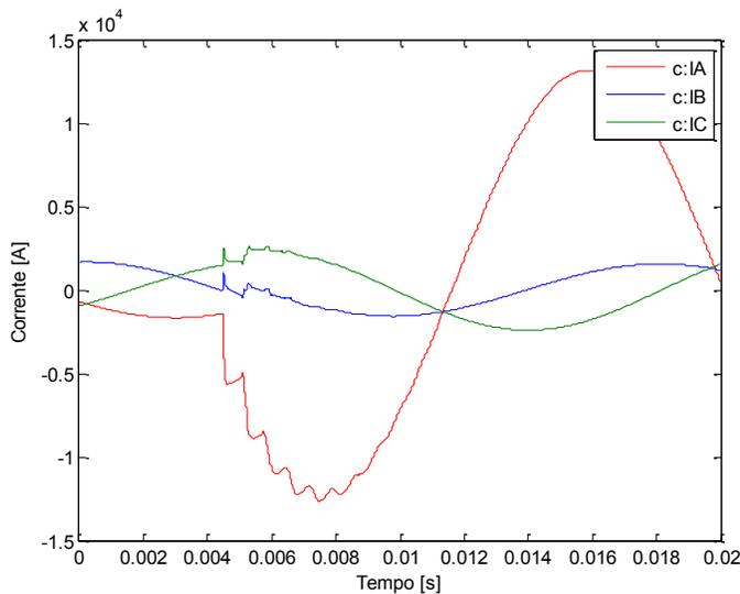
Figura 6. Sinais de Corrente para Falta Monofásica A-T
