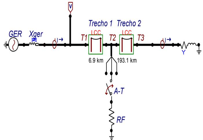
Figura 4. Sistema de Transmissão modelado no ATP
