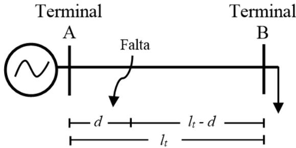
Figura 2: Linha de Transmissão com dois terminais
