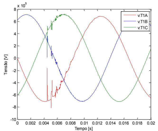
Figura 5. Sinais de Tensão para Falta Monofásica A-T
