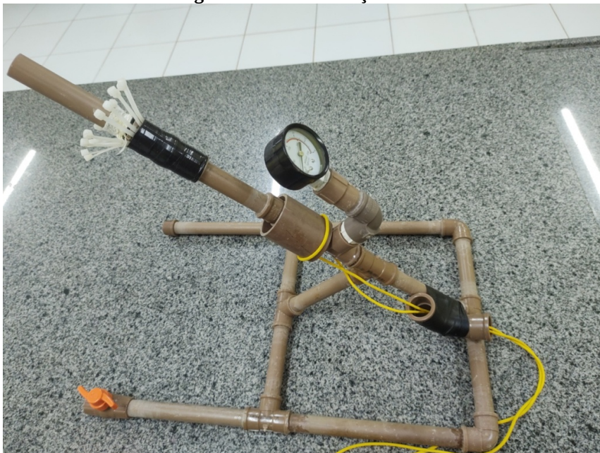
Figura 1 – base de lançamento
