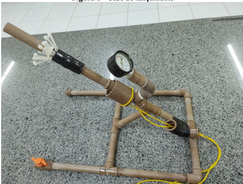
Figura 1 – base de lançamento
