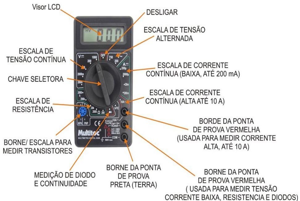
Figura 12: Multímetro e suas funções
