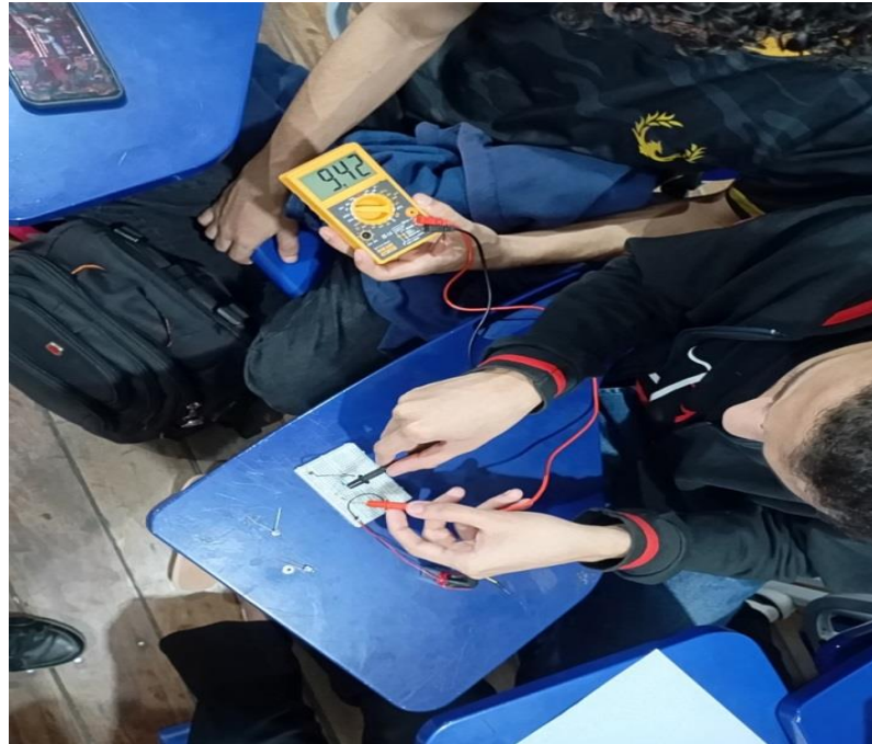
Figura 21: Medindo voltagem em um circuito em série
