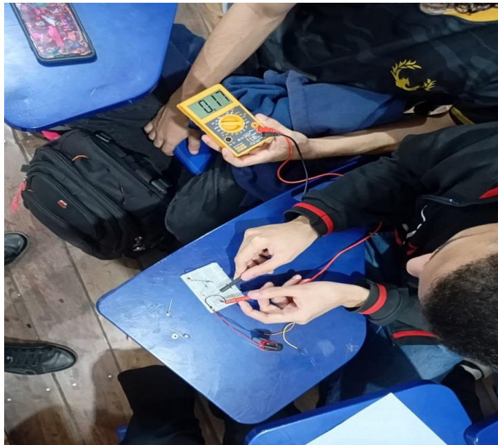
Figura 26: Medindo voltagem em um circuito em série
