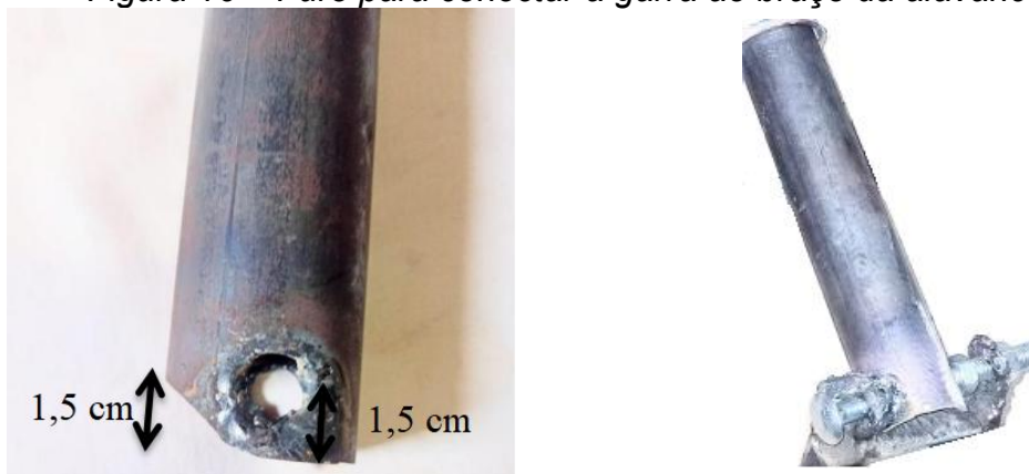
Figura 16 – Furo para conectar a garra ao braço da alavanca.
