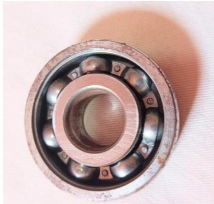
Figura 6 – Rolamento modelo 6303 T/E Bross 03-22 utilizado no projeto.
