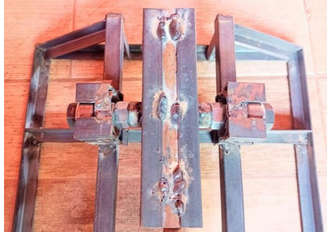
Figura 15 – Vista superior do encaixe dos rolamentos.
