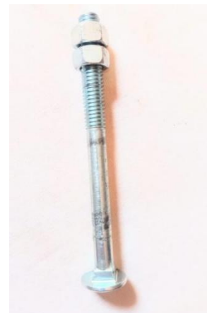
Figura 7 – Parafusos, porcas e arruelas utilizados na estrutura da alavanca.
