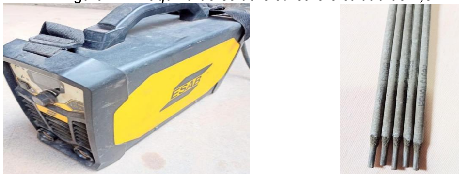
Figura 2 – Máquina de solda elétrica e eletrodo de 2,5 mm
