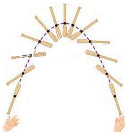
Figura 1.2: Um taco de baisebol fazendo uma trajetória parabólica onde o ponto preto representa o centro de massa.
