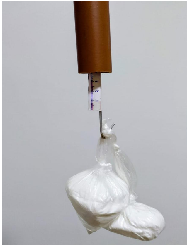
Figura 12: Detalhe do dinamômetro com peso (Fonte: Próprio autor)
