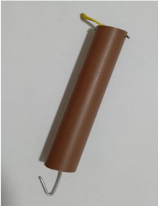
Figura 1: Dinamômetro montado. (Fonte: Próprio autor)
