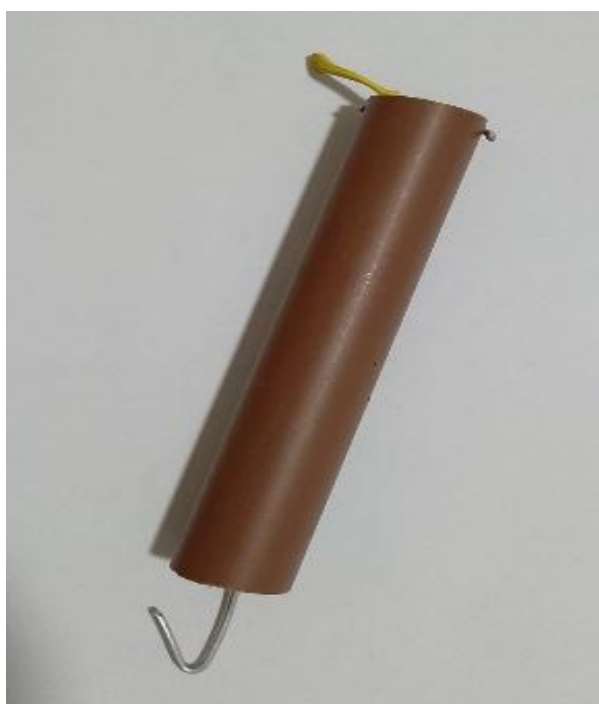
Figura 11: O dinamômetro completamente montado. (Fonte: Próprio autor)
