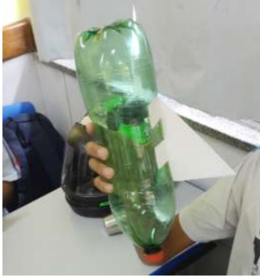
Figura 6 – fixando as aletas no corpo principal do foguete
