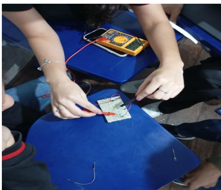
Figura 25: Medindo voltagem em um circuito em série.
