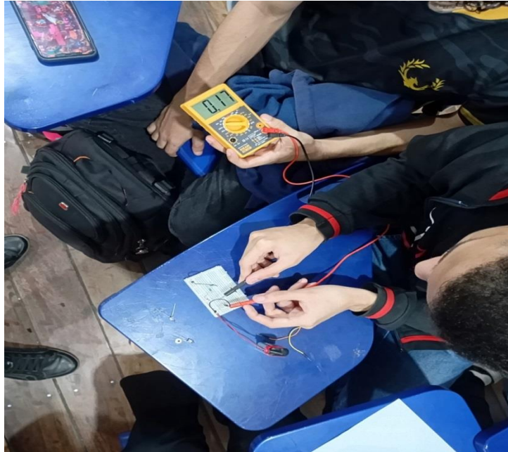
Figura 26: Medindo voltagem em um circuito em série
