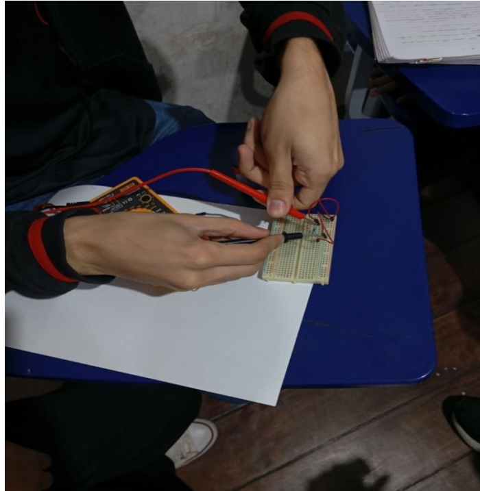
Figura 29: Medindo voltagem em um circuito em paralelo
