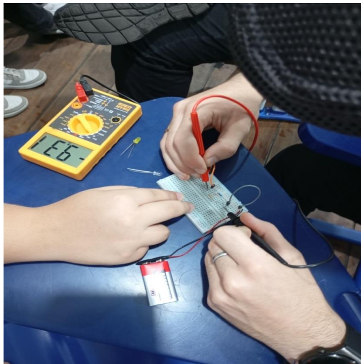
Figura 28: Medindo voltagem em um circuito em paralelo
