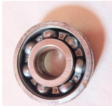
Figura 6 – Rolamento modelo 6303 T/E Bross 03-22 utilizado no projeto.
