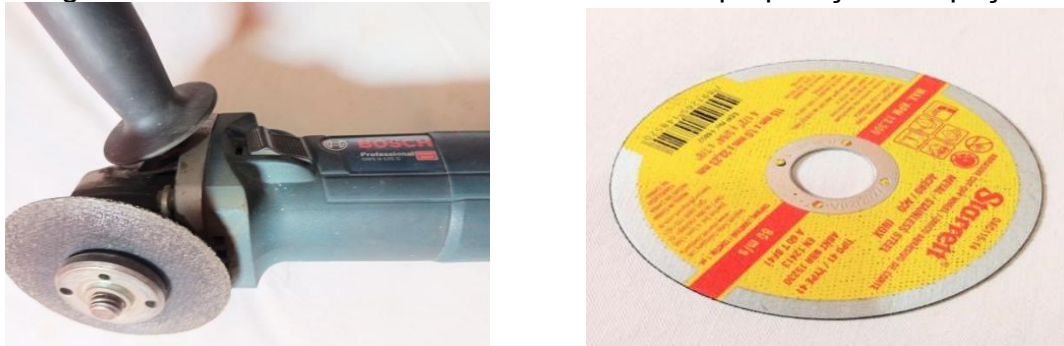
Figura 1 – Lixadeira e disco de corte usados na preparação das peças.
