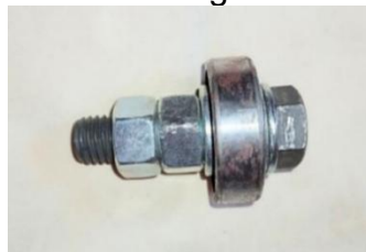
Figura 14 – Ordem de montagem de conexão do apoio.
