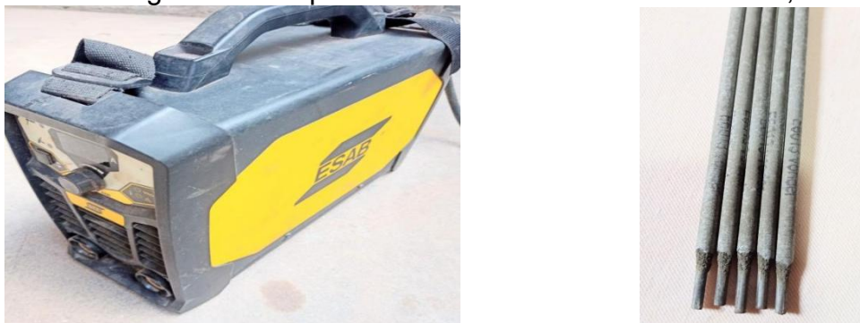
Figura 2 – Máquina de solda elétrica e eletrodo de 2,5 mm
