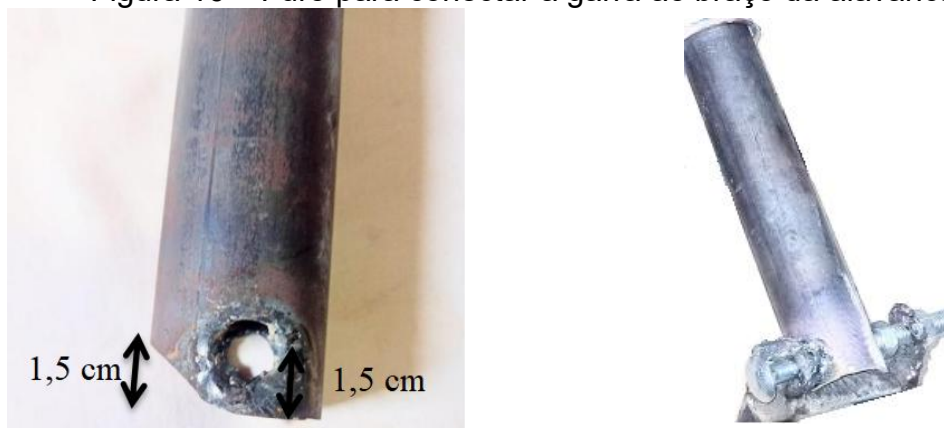
Figura 16 – Furo para conectar a garra ao braço da alavanca.
