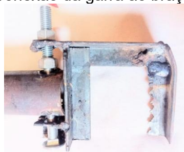
Figura 18 – Conexão da garra ao braço da alavanca.
